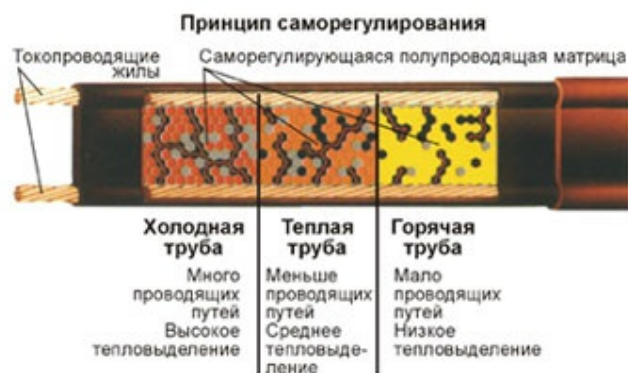
Рис.4. Принцип работы саморегулирующейся тепловыделяющей матрицы.
