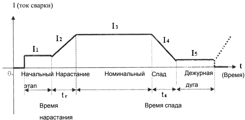
Рис. 5.4 Схема изменений тока в процессе сварки TIG постоянным током
