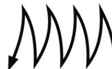
Прямые зигзагообразные движения применяют для получения наплавочных валиков при сварке встык без скоса кромок в нижнем положении и если нет вероятности прожечь деталь.
