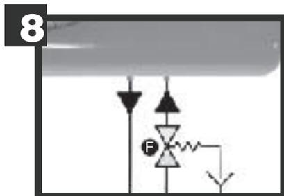
• Подводящий и отводящий патрубки должны быть рассчитаны на давление воды порядка 0,75 МПа и температуру 95 °С.
