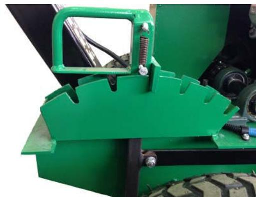
**Рис. 9** Установка рычага в положение средней глубины копания
