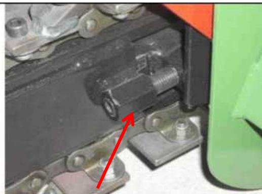
**Рис.7** Винт натяжения цепи
