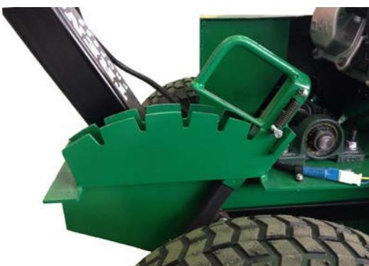
**Рис.10** Установка рычага в положение максимальной глубины копания
