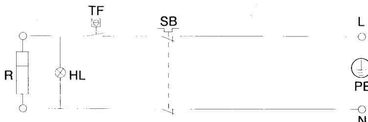
R - электрический нагревательный элемент; TF - термостат;
