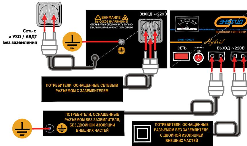
Сеть с заземлителем в проводящем кабеле.
