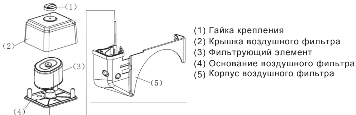
Рис. 6. Очистка / замена фильтрующего элемента
