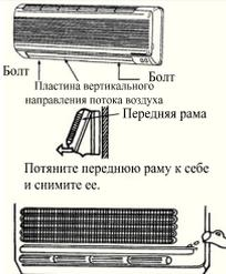
В случае, когда передняя рама возвращается на место, поверните перпендикулярную ручку направления потока воздуха от "Т" в горизонтальном направлении, а затем продолжайте в соответствии со вторым и третьим шагами. Вам следует проверить, надежно ли установлена передняя рама в пазах для крепления на верхней части.
