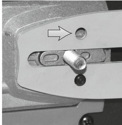
Регулярно проверяйте и при необходимости прочищайте смазочные отверстия на шине.
