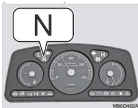
При перемещении рычага переключения диапазонов скоростей в положение нейтрали загорается данная индикаторная лампочка зеленым светом.
