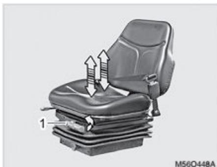
1) рычаг регулировки
