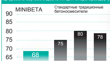
Лр уровень звукового давления для оператора, дБ(А)
