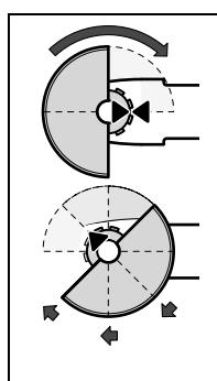
Насадите защитный кожух **11** на шейку шпинделя согласно рисунку. Треугольные метки защитного кожуха должны совпадать с соответствующими метками на головке редуктора.
