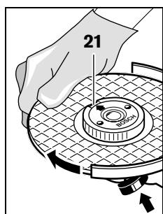
Для фиксирования шлифовального шпинделя нажмите кнопку блокировки 2. Для затягивания быстрозажимной гайки поверните шлифовальный круг с усилием по часовой стрелке.
