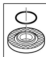
В посадочный фланец **7** вставлена вокруг буртика центрирования пластмассовая деталь (круглое кольцо). Если кольцо отсутствует или повреждено, то его следует обязательно установить или заменить (товарный № 1 600 210 039) перед монтажом посадочного фланца **7**.
