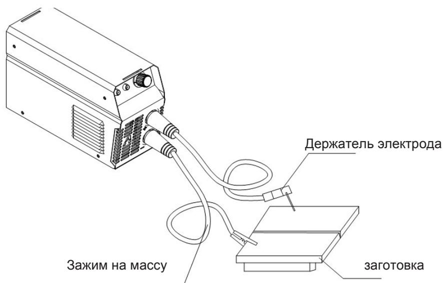
**Подключите сетевой кабель.** В комплект сварочного оборудования входит сетевой кабель. Подсоедините его к электросети с требуемыми параметрами. Проверьте надежность соединения сетевого кабеля.
