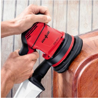
Мягкая выравнивающая накладка из вспененного материала позволяет получать более качественные результаты при шлифовании выпуклых и вогнутых поверхностей.
