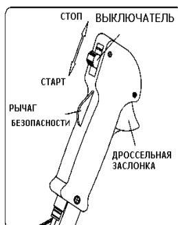
5. Одновременно нажмите на рычаг блокировки включения газа и на рычаг газа.
