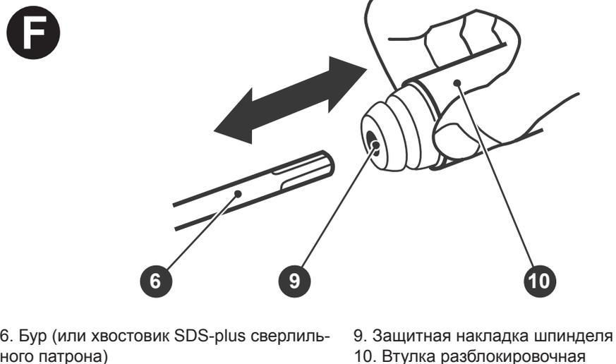
6. Бур (или хвостовик SDS-plus сверлильного патрона)
