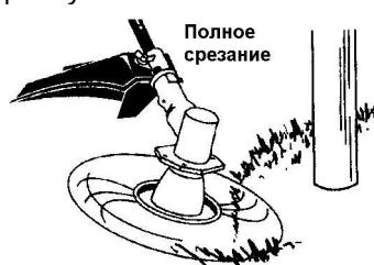
**КОШЕНИЕ** – С помощью бензокосы можно обработать труднодоступные участки газона, которые не под силу газонокосилке. При кошении удерживайте головку с леской параллельно поверхности земли. Не прижимайте головку к земле, так как это может повредить её.
