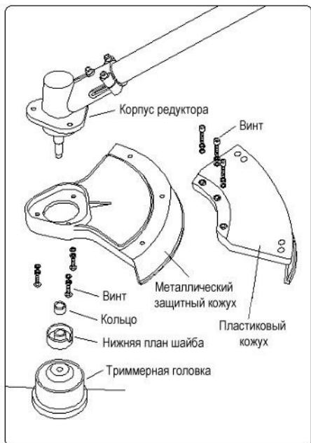
струнной головки к металлическому защитному кожуху диска необходимо присоединить тремя винтами пластиковый кожух триммерной головки
