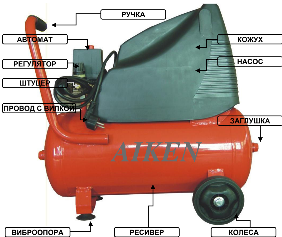
Рис.1. Компрессор воздушный поршневой коаксиальный без смазки
