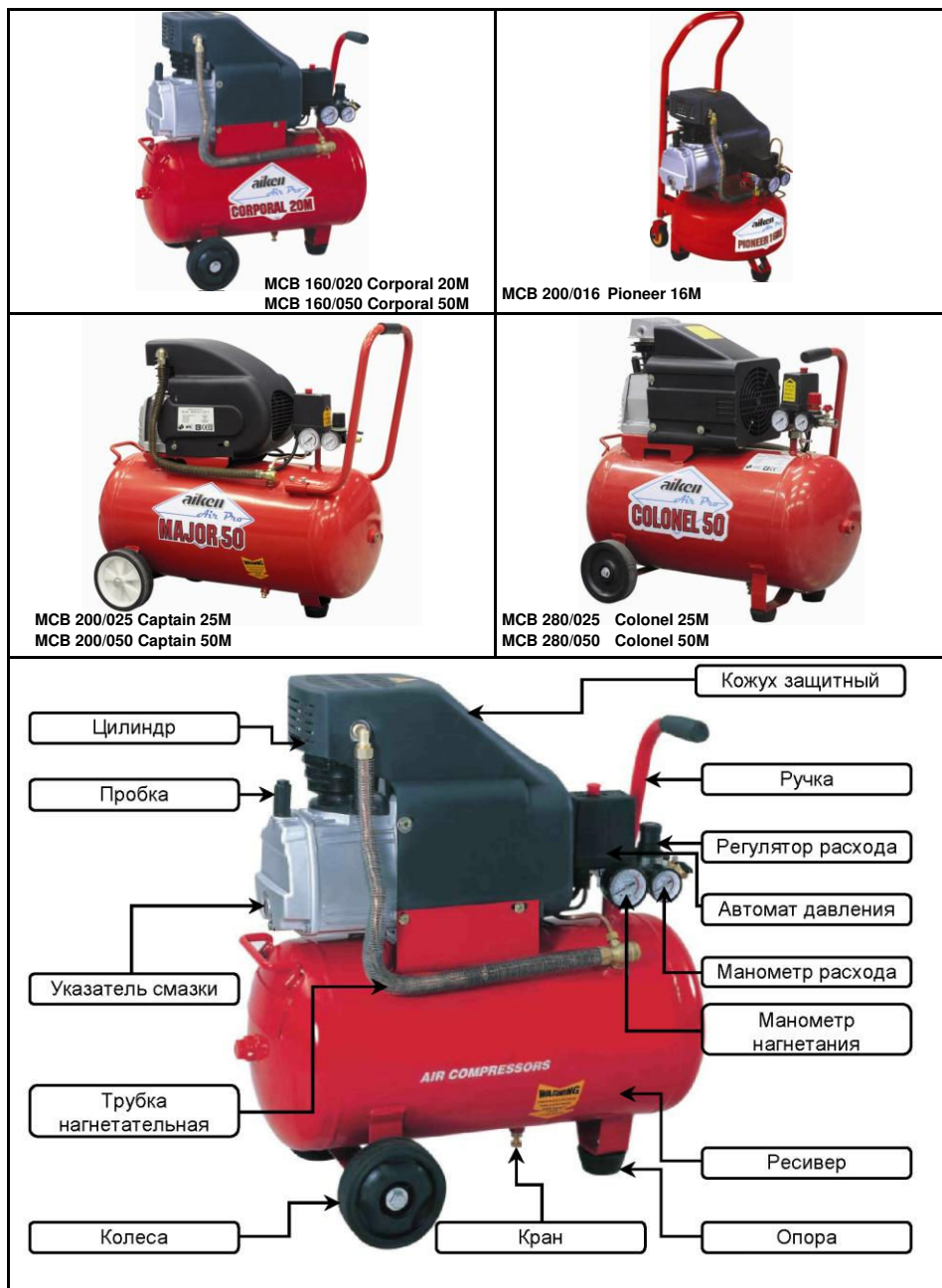
Рис.1. Компрессоры воздушные поршневые коаксиальные со смазкой. Общий вид и устройство компрессоров.
