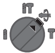
Positie Vario-Lock voor het verstellen van de hakpositie In deze stand klikt de slagstop-/draaistopschakelaar 11 niet vast.
