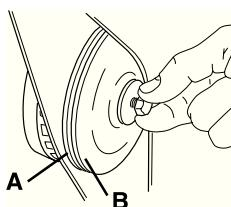
Ось можно открутить отверткой, стальным стержнем или другим подобным инструментом, который вставляется как можно дальше внутрь. диск затягивается по часовой стрелке.
