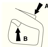
Замок триггера остается нажатым до тех пор, пока нажат дроссель. Когда вы отпускаете рукоятку, то ручка газа и фиксатор ручки газа возвращаются в свое первоначальное положение. Это осуществляется благодаря двум независимым друг от друга системам пружин. В таком положении ручка газа автоматически фиксируется на холостых оборотах.
