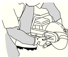
Винт, которым закреплен режущий диск должен быть затянут с усилием в 15-25 Нм.
