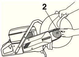
Наложите щиток ремня и зафиксируйте режущий узел вместе со щитком ремня. Затяните оба болта (4) от руки.
