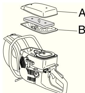
Снимите пенопластовый фильтр. Промойте тщательно фильтр в растворе теплой мыльной воды. После промывания тщательно прополосните фильтр в чистой воде. Выжмите и дайте фильтру просохнуть. **ОБРАТИТЕ ВНИМАНИЕ!** Сжатый воздух под высоким давлением может повредить пенопласт.
