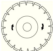
Всегда пользуйтесь только заточенным режущим алмазным диском. Чтобы заточить алмазный диск, разрежьте мягкий материал, например песчаник или кирпич.
