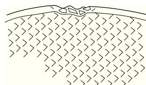
Проверяйте абразивный диск, подвесив его на пальце и слегка ударив по нему ручкой отвертки или другим подобным предметом. Если звук диска не дает полного звучания, значит диск поврежден.
