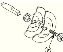
Не пользуйтесь фланцевыми шайбами с перекосом, со сбитыми краями, со следами ударов или грязными. Не пользуйтесь фланцевыми шайбами разных размеров.
