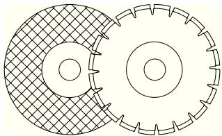
При транспортировке машины всегда снимайте режущий диск.
