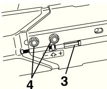
Винтите натягивающий винт (3) настолько, чтобы 4-х угольная гайка находилась напротив стрелки на щитке ремня. Потрясите узел, чтобы убедиться в том, что пружина может натягивать ремень. Это автоматически отрегулирует правильное натяжение на ремне. Затяните оба болта (4) комбинированным ключом. **ОБРАТИТЕ ВНИМАНИЕ!** При монтаже ремня, натяжение ремня должно быть затем опять отрегулировано, после того, как режущий станок использует два бака топлива.
