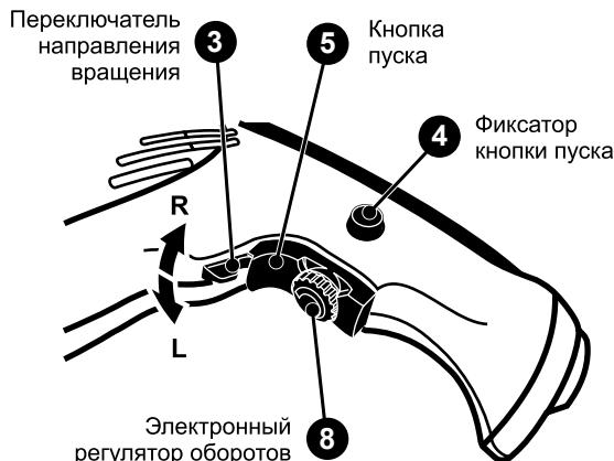
Кнопка пуска оснащена фиксатором для длительной работы.
