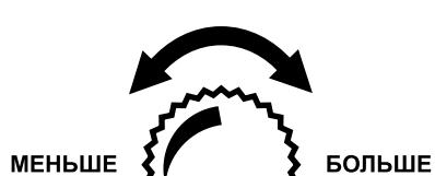
Ваша дрель оснащена плавным регулятором частоты вращения двигателя. Чем сильнее Вы нажимаете кнопку пуска 5, тем выше частота вращения. Верхний предел частоты вращения можно изменить с помощью специального колесика 8, расположенного на кнопке пуска 5. Для увеличения верхнего предела частоты вращения, вращаете колесико по часовой стрелке, а для уменьшения, против часовой стрелки, согласно пиктограмме на колесике.
