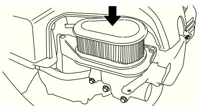
Καθαρίστε το φίλτρο κτυπώντας το φίλτρο σε μια επίπεδη επιφάνεια. Μην χρησιμοποιείτε ποτέ διαλυτικό με πετρέλαιο, για παράδειγμα, κηροζίνη ή συμπιεσμένο αέρα για τον καθαρισμό του φίλτρου.
