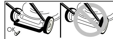
Опасность травмирования – работайте только с установленной скобой безопасности.
