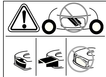
Опасность травмирования – работайте только с установленным выбрасывателем.
