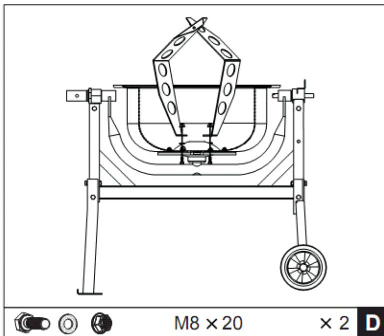
Установите лопасти в нижний барабан бетономешалки, как показано на рисунке D, закрепив с внешней стороны двумя болтами М8х20. Три шайбы (прокладка, шайба и гровер) и гайка должны быть свободно закреплены с внутренней стороны барабана. Прокладка помещается первой от лопасти.
