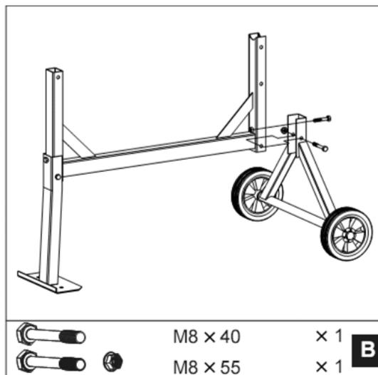
К лежащей на боку раме присоедините опорную ножку, как показано на рисунке А. Вставьте болт М8х55 в отверстие с одной стороны и закрепите его гайкой с другой стороны. Также закрутите болт М8х40 на раме. Убедитесь в надежности крепления.
