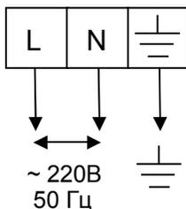
*Подключить сетевой кабель согласно маркировке рядом с клеммной колодкой.*
