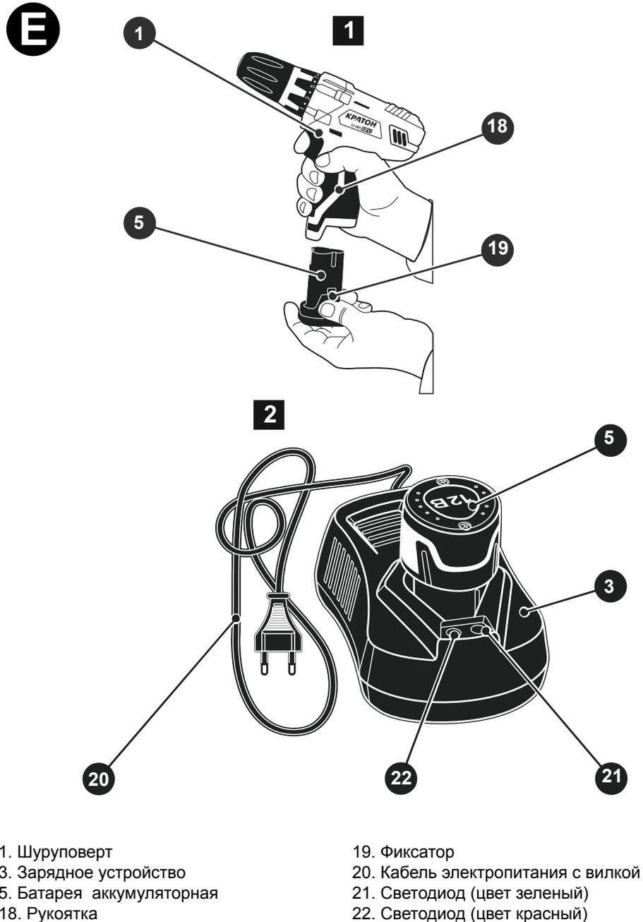
Рисунок Е — установка и зарядка аккумуляторной батареи.
