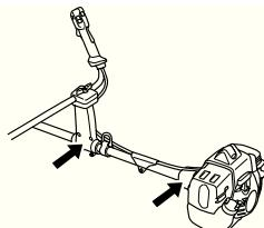
Неправильно закрепленная леска или незаточенное, неправильное режущее оборудование (не соответствующий тип или неправильно заточенные, см. раздел Затачивание лезвия) способствуют увеличению вибрации.
