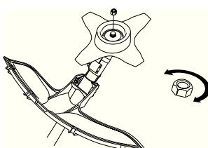
Нейлоновая прокладка контргайки не должна быть изношена настолько, чтобы ее можно было поворачивать вручную. Прокладка должна выдерживать усилие минимум 1,5 Нм. Гайку следует заменить после ее использования приблизительно 10 раз.
