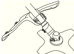
Проверьте, чтобы защита не была повреждена и чтобы на ней не было трещин. Замените защиту, если она была подвергнута удару или если на ней есть трещины.
