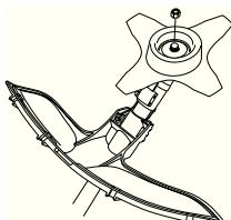
При сборке надо затягивать гайку против направления вращения режущего оборудования. При разборке надо отвинчивать гайку в направлении вращения режущего оборудования. (ЗАМЕЧАНИЕ! Гайка имеет левостороннюю резьбу.) Затяните гайку торцевым гаечным ключом.
