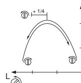
**ВНИМАНИЕ!** Если режущее оборудование вращается или подвижно при работе на холостых оборотах, винт T следует вращать против часовой стрелки до тех пор, пока режущее оборудование не остановится.
