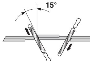
Отрегулируйте разводку. Она должен составлять 1 мм.
