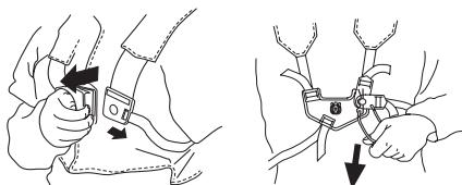
Убедитесь, что привязные ремни оснастки были правильно расположены. Когда машина будет отрегулирована, проверьте работу системы быстрого отстегивания оснастки.
