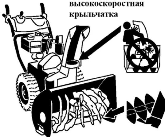
Низкоскоростной шнек имеет двигающуюся зону защемления, расположенную близко к отверстию.
