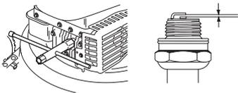
**ВНИМАНИЕ!** Используйте только свечи рекомендованной марки. Применение неподходящих свечей чревато повреждением поршня/цилиндра.
