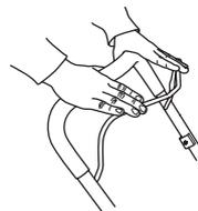
Система остановки работы мотора должна быть отрегулирована таким образом, чтобы мотор останавливался в течение 3 секунд.
