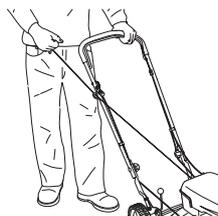
**ВНИМАНИЕ!** Не вытягивайте шнур стартера на всю длину и не отпускайте резко ручку стартера, когда его шнур полностью размотан. Это может повредить мотор.
