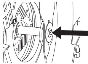
При установке ножа обратно на машину затягивайте его с крутящим моментом 45-60 Нм. См. инструкции в разделе "Сборка".
