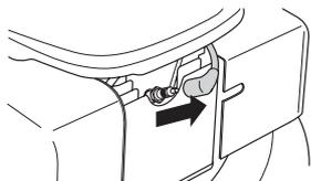
Отверните крышку маслоприемника и проверьте уровень масла по щупу, который крепится к крышке.
