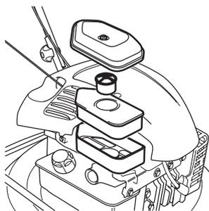
Поднимите крышку и снимите воздуховод.
