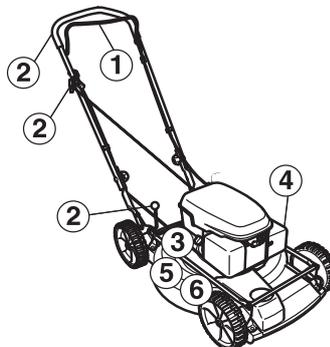
1. Убедитесь в исправности ручки остановки работы мотора. См. инструкции в разделе "Проверка эффекта остановки".
