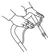
Не прикрепляйте ручку остановки мотора к ручке управления подручными средствами при работе на машине.
