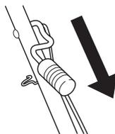
Выключите мотор, отпустив ручку остановки мотора.
