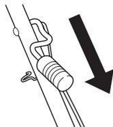
Подтяните левой рукой ручку остановки мотора к рычагу управления газонокосилкой.
