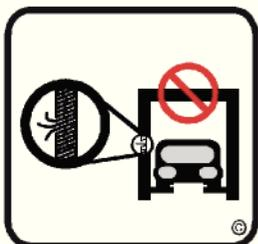
**НЕ СЛЕДУЕТ РАБОТАТЬ С ПОДЪЕМНИКОМ ПРИ ОБНАРУЖЕНИИ ПОВРЕЖДЕНИЙ ТРОСА СИНХРОНИЗАЦИИ**
