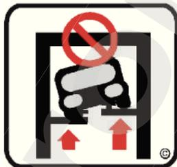
**ПРИ ОБНАРУЖЕНИИ НАРУШЕНИЯ РАВНОВЕСИЯ КАРЕТОК ИСПОЛЬЗОВАНИЕ ПОДЪЕМНИКА ЗАПРЕЩЕНО**
