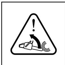
Осторожно, опасность отдачи. Соблюдать осторожность при внезапном и случайном движении направляющей шины вверх или назад.
