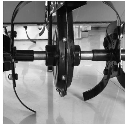
Каждый раз перед началом культивации проверяйте состояние редуктора, вала редуктора, фрез и креплений. При наличии масляных пятен на редукторе или вале обратитесь в сервисный центр. Если фрезы пришли в негодность закажите новые.
