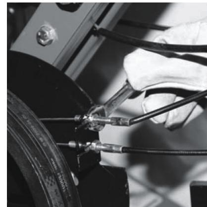
Со временем тросы привода могут растянуться. Для их регулировки необходимо расконтрить гайки и добиться оптимального натяжения тросов.
