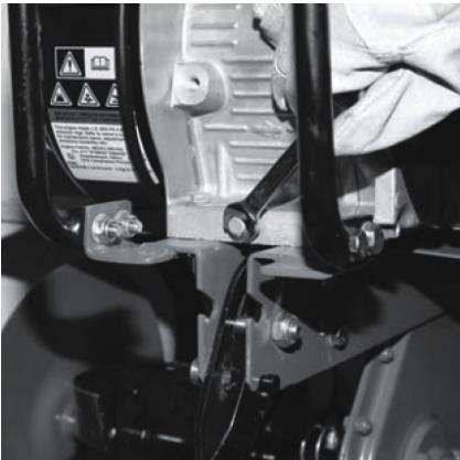
Открутите болт сливного отверстия и крышку маслозаливной горловины.
