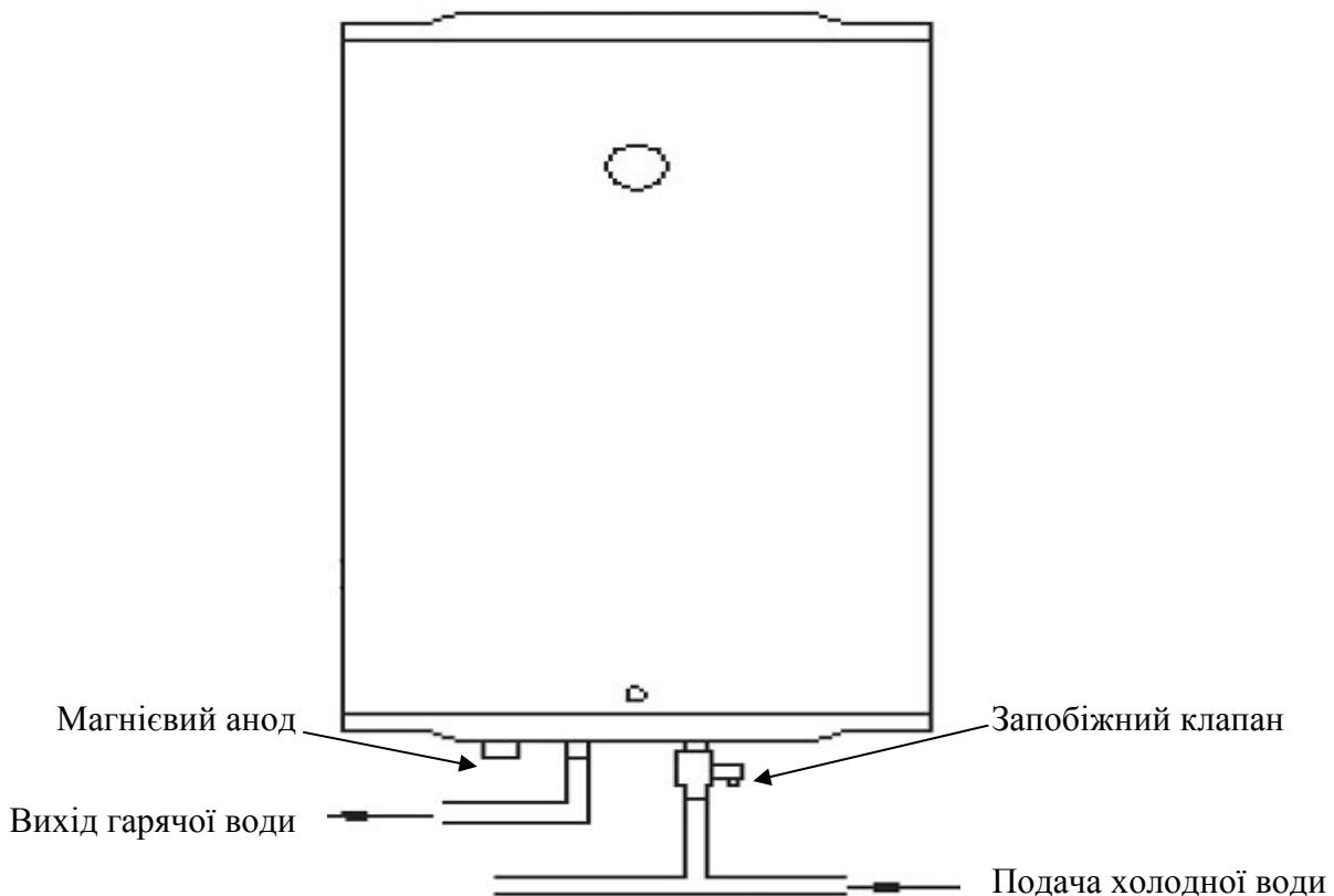
Щоб уникнути поломки при загвинчуванні запобіжного клапана не застосовуйте великих зусиль.
