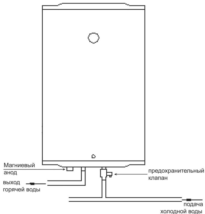
Во избежание поломки при завинчивании предохранительного клапана не применяйте больших усилий.
