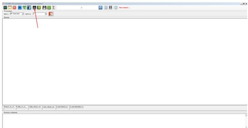
Указать IP адрес компьютера и порт TCP для связи с установкой, нажать «Сохранить данные»
