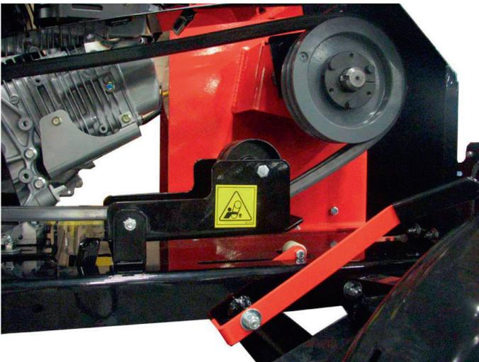
Рис. 5.4. Ручка включения в положении ИЗМЕЛЬЧЕНИЕ
