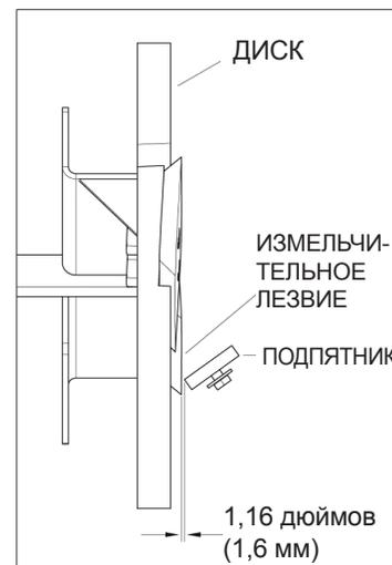
Рис. 5.2. Зазор между измельчительным лезвием и измельчительным подпятником
