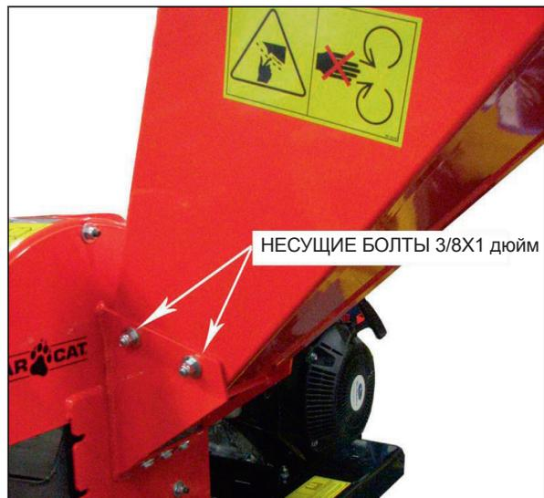
Рис. 2.2. Лоток измельчителя
