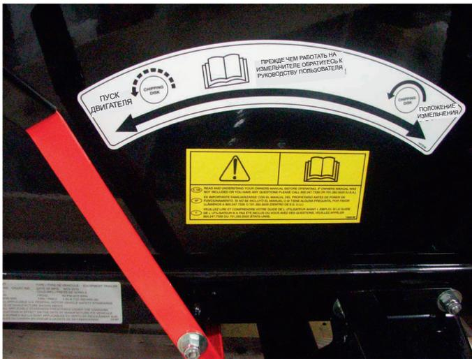
Рис. 5.3. Ручка включения в положении START
