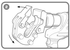
Откройте рабочую голову, нажав на фиксатор. Установите трос или пруток в рабочую зону. Закройте рабочую голову, защелкнув фиксатор.
