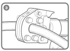
Нажмите на кнопку «ПУСК» и держите нажатой ее до срабатывания механизма автоматического сброса давления. При этом раздается характерный щелчок.
