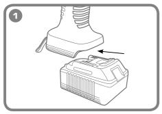
Вставьте аккумулятор в корпус инструмента до щелчка, при этом прозвучит характерный сигнал и сработает световая индикация. Аккумулятор устанавливается только в одном положении.
