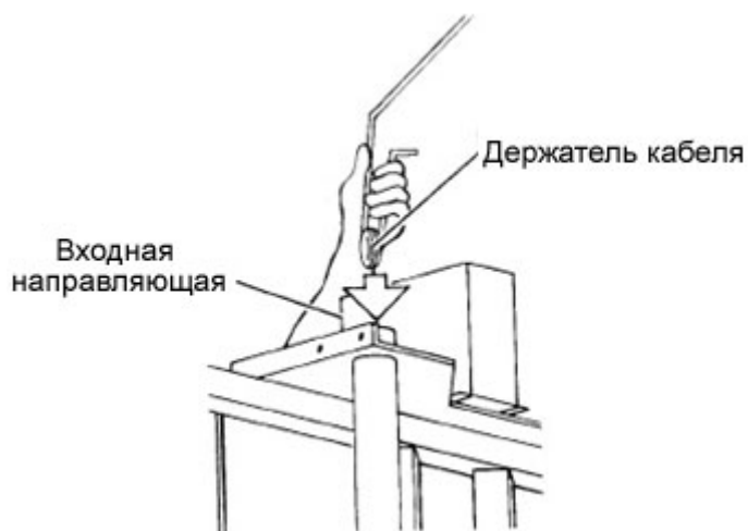
РИС. 8. Установка держателя кабеля питания
