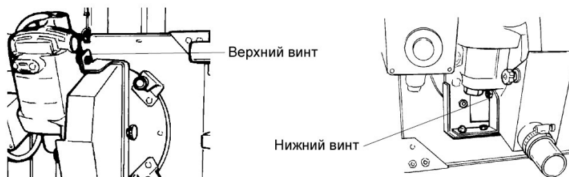
РИС. 29. Снятие мотора на станках 6400, 6800, P7
