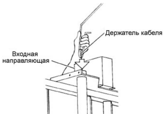
РИС. 8. Установка держателя кабеля питания
