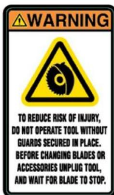
Не работайте на станке без защитного кожуха пильного диска
