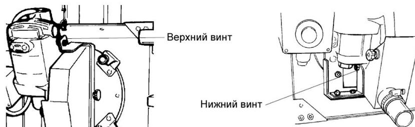
РИС. 29. Снятие мотора на станках 6400, 6800, P7
