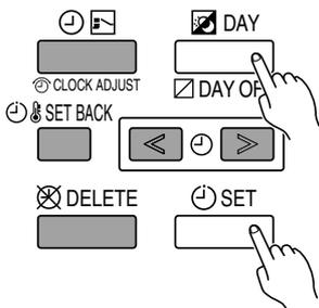
Нажмите одновременно кнопку отключения DAY (DAY OFF) и кнопку настройки SET на 2 секунды или более для активирования функции ограничения доступа детей и блокировки всех кнопок на пульте дистанционного управления. Нажмите эти кнопки на 2 секунды или более для отмены этого режима.
