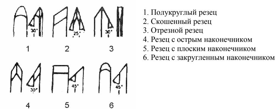
Рис. 16 – Шесть наиболее распространенных типов резцов
