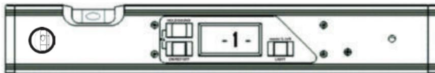
2. Поверните прибор на  $180^\circ$ , не меняя положения. Нажмите на кнопку А. На дисплее начнет мигать значок “-2-”. Не двигайте прибор, пока не завершится процесс калибровки.
