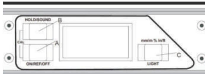
сигнала. Звуковой сигнал появляется при горизонтальном положении  $0^\circ$  и вертикальном положении  $90^\circ$ . Прерывистый звуковой сигнал становится постоянным при приближении к  $0^\circ$  и  $90^\circ$ .
