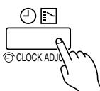
Нажмите кнопку выбора режима работы таймера для включения таймера (ON) или выключения (OFF).
