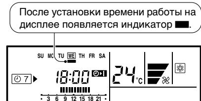
напр., таймер установлен на 7:00-18:00.
