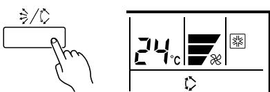
Нажмите кнопку настройки направления и колебания воздушного потока по вертикали на 2 секунды или более для выбора режима работы или останова колебаний.
