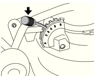
Поднимите режущий блок, прежде чем регулировать высоту.
