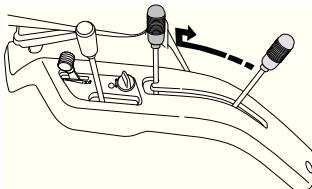
При перемещении рычага вперед режущая дека опускается, и ножи автоматически начинают вращаться (положение стрижки).
