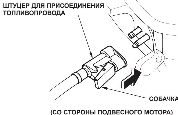
2. Присоедините топливный штуцер к топливному баку. Соединительный штуцер должен устанавливаться собачкой к рычагу реверса. Обратите внимание на то, чтобы штуцер со щелчком встал на место.
