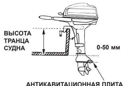
Проверьте, чтобы высота транца лодки соответствовала подвесному мотору. Неправильное положение по высоте снизит эффективность подвесного мотора. Подвесной мотор должен быть установлен так, чтобы антикавитационная плита располагалась ниже плоскости днища лодки на 0-50 мм.
