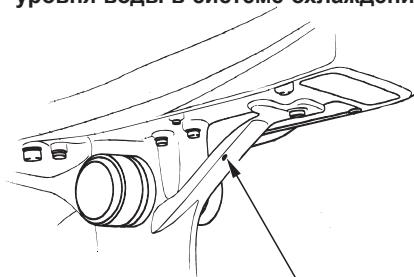
Контрольное отверстие служит для контроля нормальной циркуляции воды в системе охлаждения двигателя.
