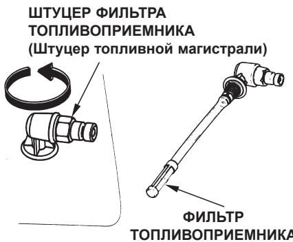
1. Поверните топливоприёмник против часовой стрелки и выньте его из топливного бака.
