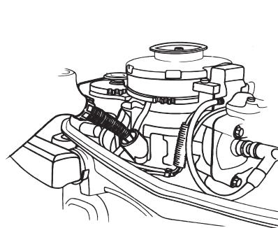
3. Залейте рекомендуемое масло в двигатель до верхней отметки на щупе. Наденьте крышку маслоналивной горловины, не наворачивая её, снимите и проверьте уровень масла.
