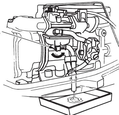
1. Отсоедините разъём топливопровода и установите заглушку на штуцер. Плотно закройте клапан вентиляции на крышке наливной горловины (см. стр. 50).
