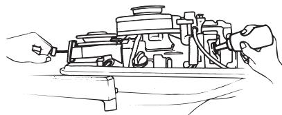
4. Замените моторное масло (см. стр. 61). Если в картере двигателя была вода либо в масле, слитом из двигателя имеются признаки попадания воды, то после получасовой работы двигателя масло следует заменить ещё раз.
