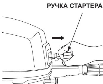
Для запуска двигателя потяните ручку стартера. Перед запуском двигателя установите рычаг реверса в положение N (нейтраль).
