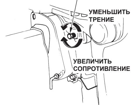
Для обеспечения плавного управления отрегулируйте фрикционный демпфер так, чтобы при вращении ощущалось лёгкое сопротивление.
