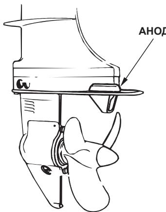
Перо триммера выполняет роль разрушающегося анода, который защищает подвесной мотор от коррозии.
