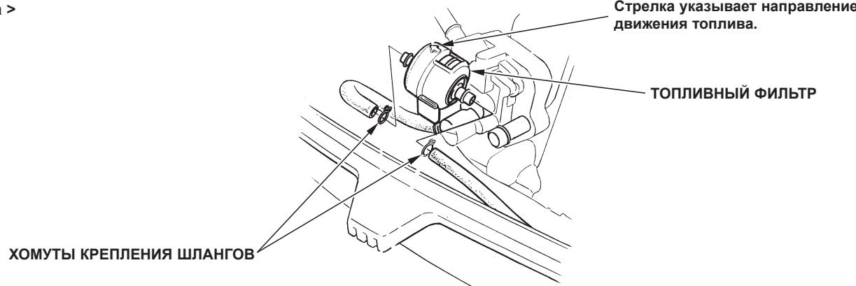
1. Отсоедините шланг, ведущий от топливного бака к двигателю.
