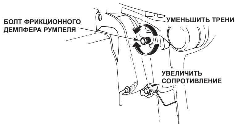
При буксировке или перевозке лодки с установленным подвесным мотором рекомендуется оставить подвесной мотор в нормальном рабочем положении и надежно затянуть винт фрикционного демпфера румпеля.
