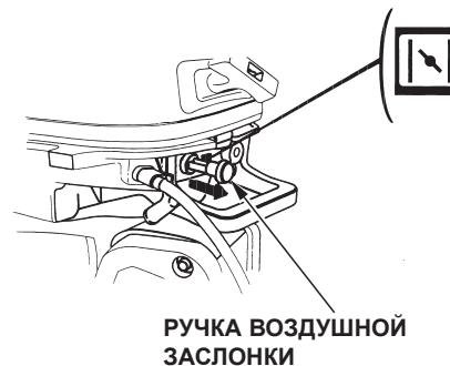
Для облегчения запуска холодного двигателя нужно вытянуть ручку воздушной заслонки непрогретого двигателя. Вытягивание ручки управления воздушной заслонки обогащает рабочую смесь.
