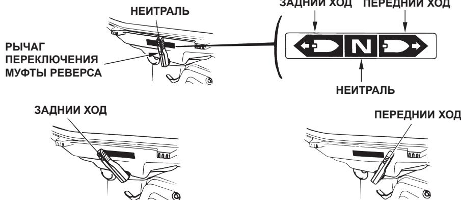
Рычаг переключения муфты реверса имеет три фиксируемых положения: FORWARD (передний ход), NEUTRAL (нейтраль) и REVERSE (задний ход). Указатель на рычаге переключения муфты реверса совмещается с пиктограммой на корпусе переключателя.
