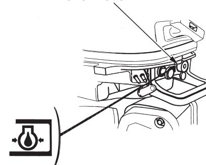
6. После запуска двигателя следует убедиться в том, что горит сигнальная лампа давления масла. Если сигнальная лампа не включается, то остановите двигатель и проверьте следующее.
