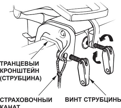
Установите струбцину на транец и затяните винты крепления.
