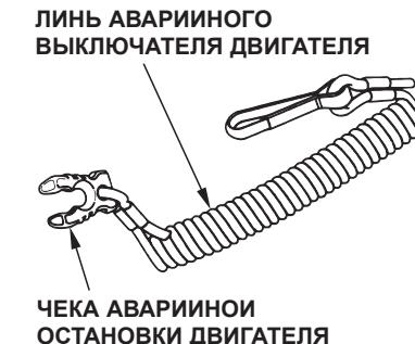
Линь аварийного выключателя двигателя предназначен для экстренного глушения двигателя при падении судоводителя за борт или в случае потери равновесия, когда теряется возможность управления подвесным мотором.
