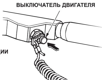
Нажмите на выключатель, для того чтобы остановить двигатель.
