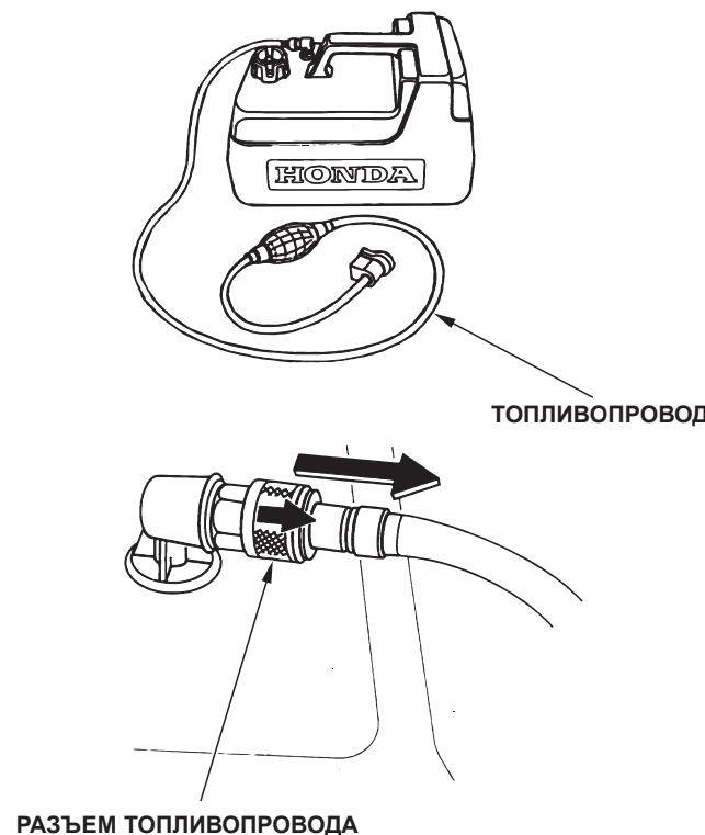
Топливный бак и фильтр топливоприёмника следует промывать ежегодно или каждые 200 моточасов.
