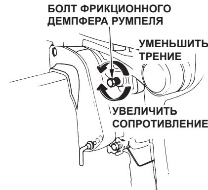
Болт фрикционного демпфера румпеля позволяет регулировать сопротивление перемещению румпеля.
