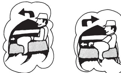
При повороте лодки корма смещается в противоположную сторону относительно направления поворота. Для того чтобы повернуть лодку вправо, поверните румпель влево. Для того чтобы повернуть лодку влево, поверните румпель вправо.
