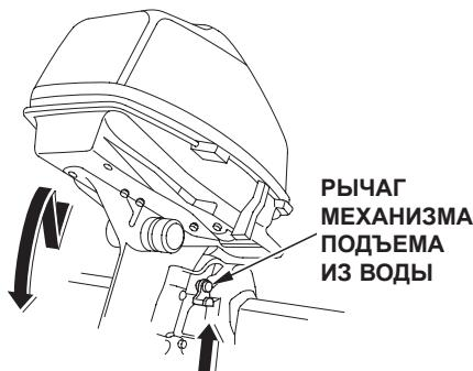
Используйте рычаг механизма для временного подъема подвесного мотора из воды, когда лодка движется по мелководному участку, подходит к причалу или устанавливается на якорь на мелководье. При поднятом рычаге расцепляется замок двигателя и мотор можно поднять из воды. При опускании рычага подвесной мотор фиксируется.
