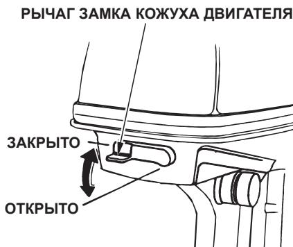
Для того чтобы снять капот двигателя или закрепить его после установки, соответственно, поднимите рычаг фиксатора и отведите запорную скобу или установите скобу и опустите рычаг фиксатора.
