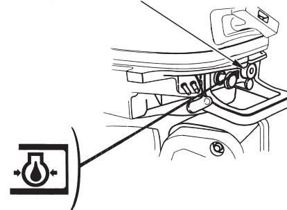
При низком уровне моторного масла или неисправности системы смазки двигателя индикатор нормального давления выключается.
