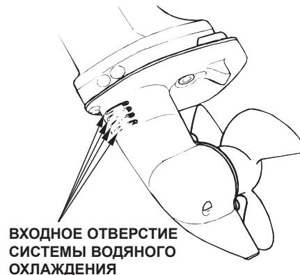
Через входное отверстие вода поступает в систему охлаждения двигателя.
