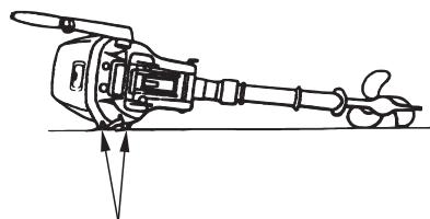
Уложите подвесной мотор на защитную подкладку. (Румпелем вверх)
