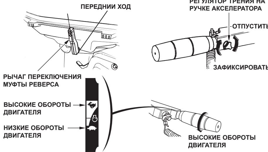
1. Для того чтобы увеличить скорость хода лодки, поверните рукоятку акселератора в направлении **ВЫСОКИЕ ОБОРОТЫ ДВИГАТЕЛЯ**. При этом рычаг переключения муфты реверса должен находиться в положении **ПЕРЕДНИЙ ХОД**.
