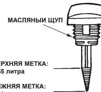
4. Установите на место и плотно затяните крышку маслоналивной горловины.
