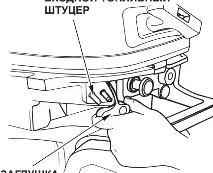
Нажимая на собачку разъёма топливопровода, потяните за разъём и отсоедините топливопровод от штуцера на подвесном моторе. Наденьте заглушку на штуцер топливопровода. Плотно закройте клапан вентиляции на крышке наливной горловины.
