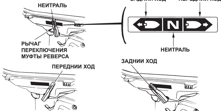
Рычаг переключения муфты реверса предназначен для включения переднего или заднего хода, а также для отключения двигателя от гребного винта. Предусмотрено три фиксируемых положения рычага. Запуск двигателя возможен только если рычаг переключения муфты реверса находится в положении NEUTRAL.
