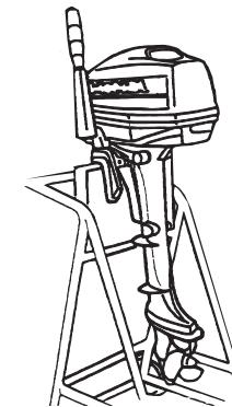
2. Установите рычаг переключения муфты реверса в положение ЗАДНИЙ ХОД (REVERSE).
