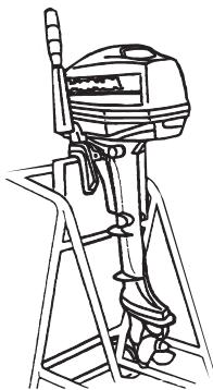
1. Закрепите струбцины на подмоторной стойке и установите мотор на струбцинах, (стр. 23).
