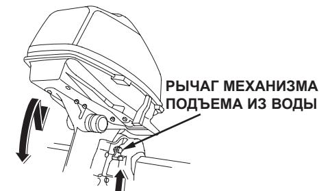
3. Установите рычаг регулировки положения в положение "TILT" и выберите угол наклона 30°, 45° и 70°.
