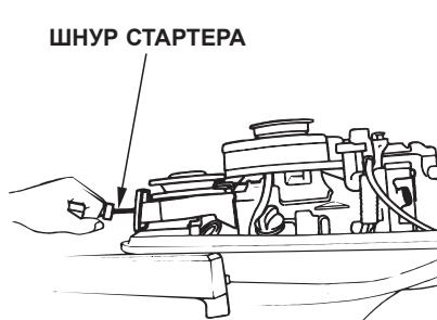
3. Выверните свечу зажигания. Снимите чеку с аварийного выключателя двигателя и несколько раз потяните шнур стартера, чтобы полностью удалить воду из цилиндров.
