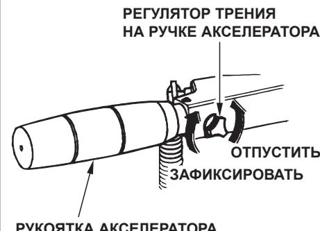
Маховикочек предназначен для регулирования сопротивления вращению рукоятки акселератора. Для закрепления положения рукоятки акселератора при движении с постоянной скоростью нужно повернуть маховикочек по часовой стрелке. Для облегчения вращения рукоятки акселератора поверните маховикочек против часовой стрелки.
