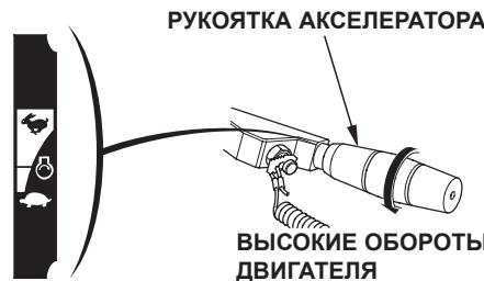
Обороты двигателя регулируются поворотом рукояти по или против часовой стрелки. При повороте рукоятки в направлении показанной на рисунке стрелки обороты двигателя увеличиваются.
