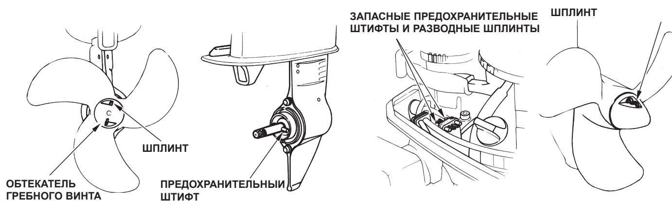
Предохранительный штифт предназначен для защиты гребного винта и трансмиссии от ударных нагрузок, возникающих задевании препятствий гребным винтом.
