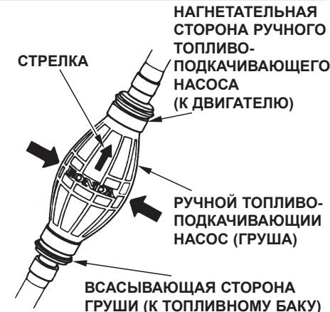
3. Возмите грушу так, чтобы нагнетательная сторона была выше всасывающей. Стрелка на груше должна быть направлена вверх. Сожмите грушу несколько раз пока не почувствуете увеличения сопротивления сжатию, указывающего на то, что топливо достигло карбюратора. Проверьте, чтобы не было подтеков топлива и устранийте их до запуска двигателя.
