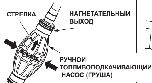
Груша для подкачки топлива последовательно встроена в шланг подачи топлива от топливного бака к двигателю.
