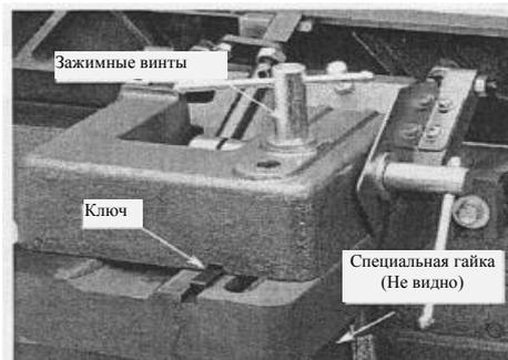
Рисунок 3. Опорный механизм линейки.
