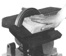
Рис. 21. Поворотное шлифование в диапазоне от 0° до 60° слева направо
