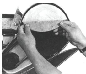
Рис. 11. Установка новой шлифовальной ленты
