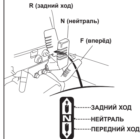
Ручка переключения хода (реверс) (модификация Н)
